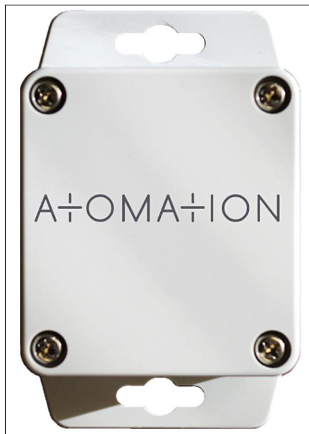
感測器可測量振盪，以確定機器電機的振動是否比昨天更大；或者監測溫度，以檢查機器運行時軸承是否發熱。每個 Atom 使用 3.6V 鋰離子電池，可工作長達三年時間。感測器在本地監控和處理資訊，不必向中央系統持續發送資料。當超出閾值或設備運行超出正常參數時，就會通過低功耗藍牙無線連接將資料發送到閘道。
