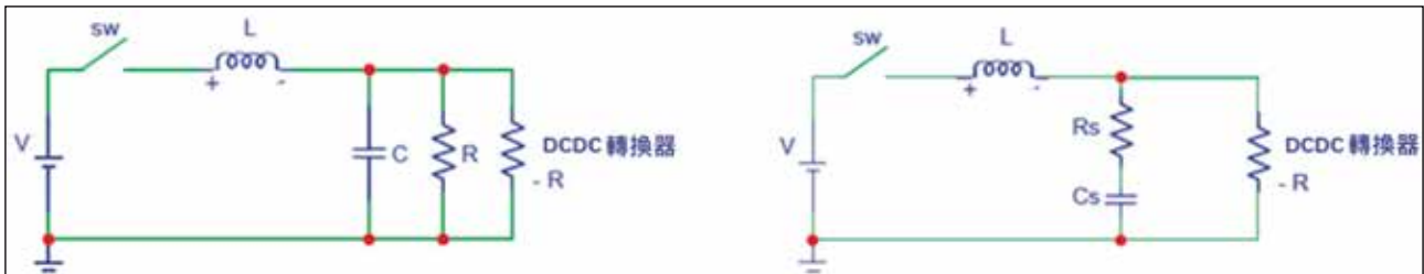
圖 5: 可能的解決方案 — 導入耗散電阻 ( 圖片來源於 Bel Fuse)
