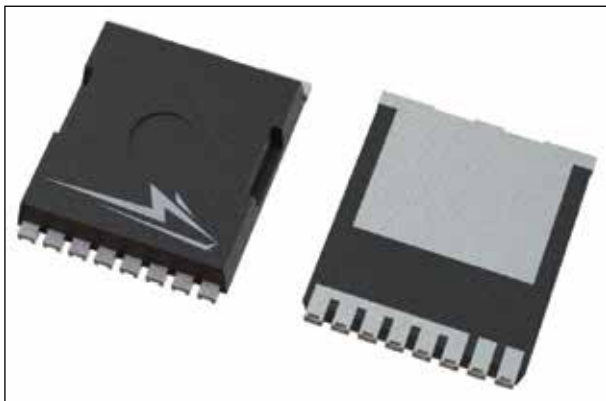
圖 5：Wolfspeed 的 TOLL 封裝明顯小於標準的 TO-263，並且支援低成本表面貼裝。
