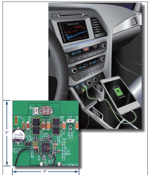
圖 1: 1 平方英寸大小的高效率、低 EMI USB Type-C 電源解決方案。
