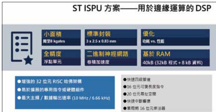
圖 3：ISPU 超低功耗可編程內核是專為機器學習與數據處理而特別設計的 DSP
