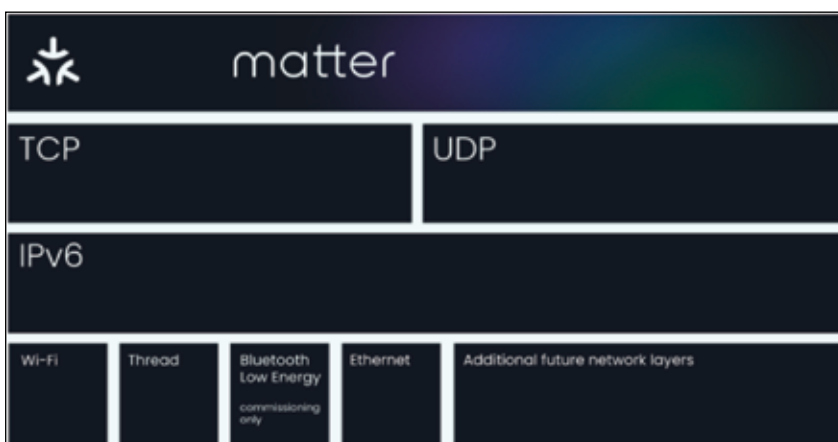
圖 1：Matter 建立在互聯網協定 (IP) 之上，以安全和隱私為主要設計原則，可為物聯網提供經驗證的設備身分以及安全的通訊和訪問控制
