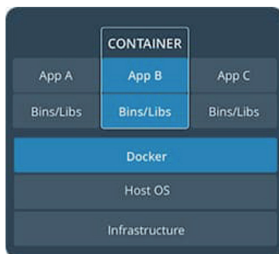
圖 6：容器提供一種資源友好的方式，可將託管於開道器、PLC 或工業電腦等設備的邊緣運算程序隔離
