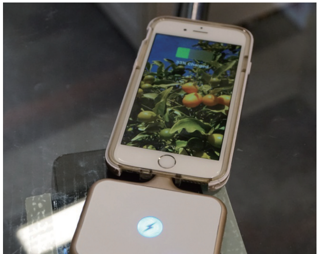
圖 2：捷佳科技的桌下型充電器不挑材質，木質或玻璃皆可穿透
