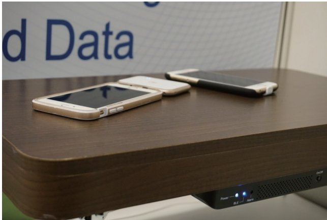
圖 1：捷佳科技的桌下型充電器，即使桌面厚達 6 公分亦可正常運作
