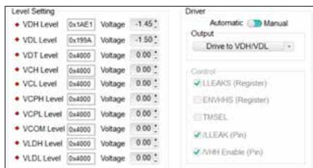
圖 7: 使用評估板軟體設定 MAX9979 的 DAC 位準。
