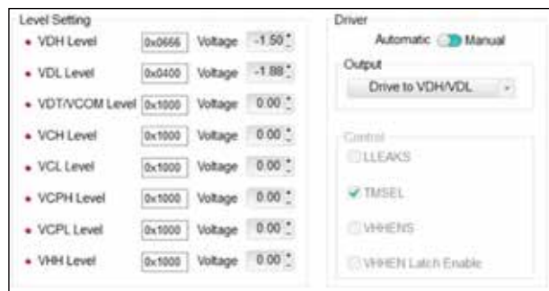
圖 4: 使用評估板軟體設定 MAX32007 的 DAC 位準。
