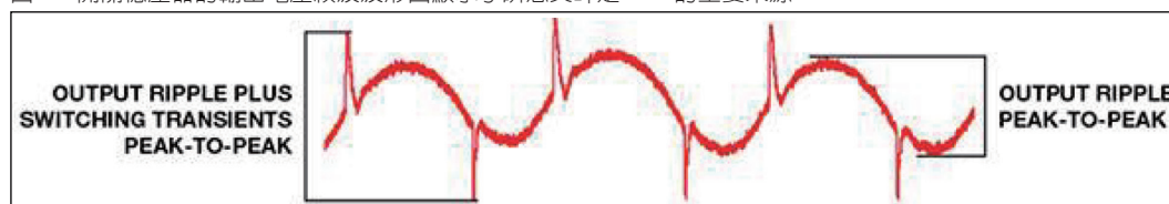
圖 1：開關穩壓器的輸出電壓紋波波形圖顯示了瞬態尖峰是 EMI 的主要來源。
