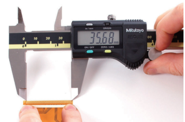
圖 5：測量 FPC ( 柔性電路板 ) 的間距
