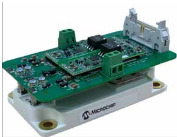
圖 2：模組適配器板與柵極驅動器核心相結合，提供了一種透過增強型開關快速評估和優化新 SiC 功率元件的平臺
