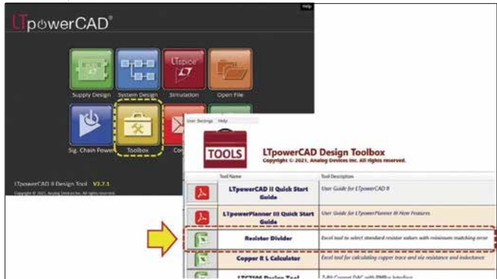
圖 3: LTpowerCAD 電阻分壓器工具：電阻對推薦
