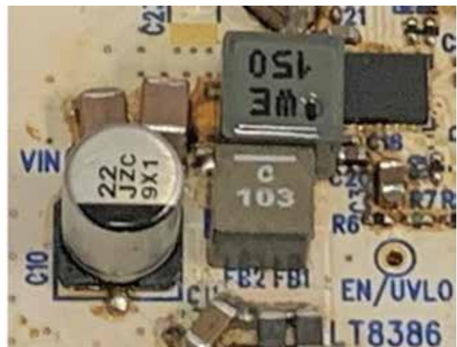
圖 11: 採用 DC3008A LT8386 LED 驅動器的 Würth 74439346150("WE 150") 電感方向輻射測試。L1 方向 1 (左), 繞組的短端子起始點在 SW 節點上; L1 方向 2 (右), 長端子在 SW 節點上。輻射結果如圖 12 所示, 顯示繞組起始點應連接到 SW 節點以獲得優質效果。
