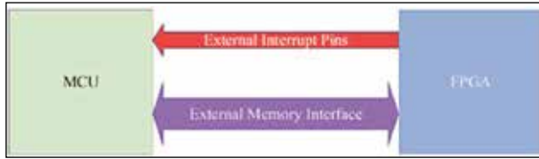
圖 1：一般性輔助處理器示意圖 (MCU + FPGA)。
