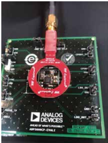
圖 5: 採用 ADP5600 評估板的電磁輻射干擾測試設定
