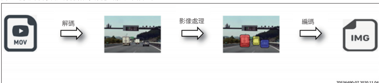
圖 7：使用深度學習進行視頻和影像處理的典型資料流程
