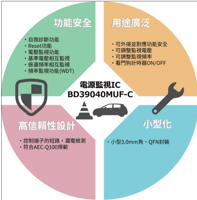
圖 8: 電源監控 IC“BD39040MUF-C”的特點
