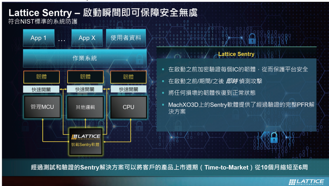
圖 4：此圖展示了基於萊迪思 Sentry 的 PFR 應用如何即時保護系統中的所有韌體實例。
