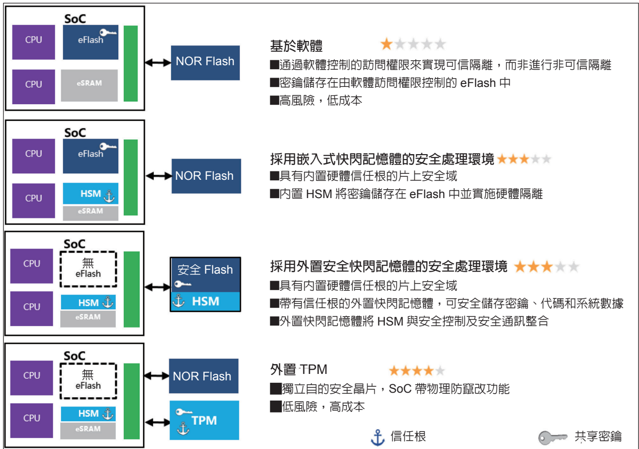
圖 2：實施信任根的方法有很多，不同設計均需權衡風險與成本
