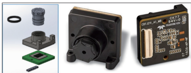
圖 10: 使用整合焦鏡頭和 Snappy 感測器的 MIPI 光學模組 (MOM)
