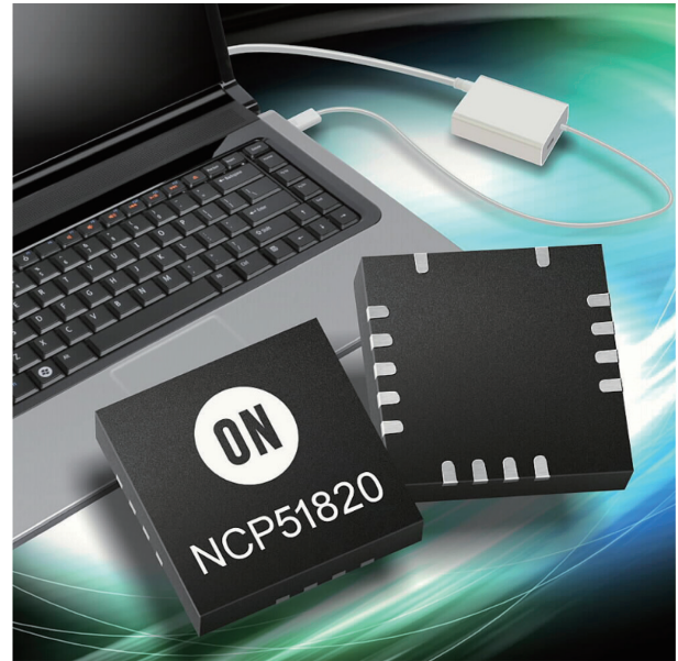
圖 2：NCP51820 高性能、650 V 半橋門極驅動器用於 GaN 電源開關
