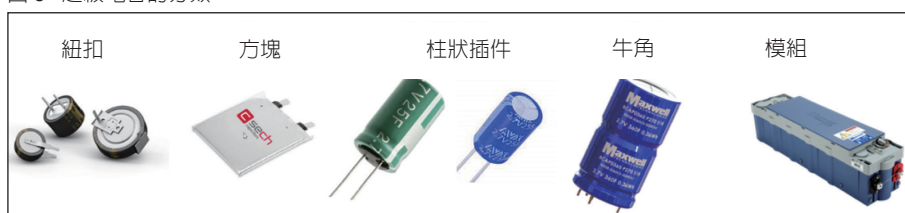
圖 5：超級電容的分類
