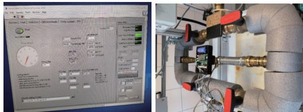
可以看出圖中的在該溫度，全流量下，測量結果保持穩定狀態，時間差在幾個波峰處會有週期跳變，屬正常現象。
