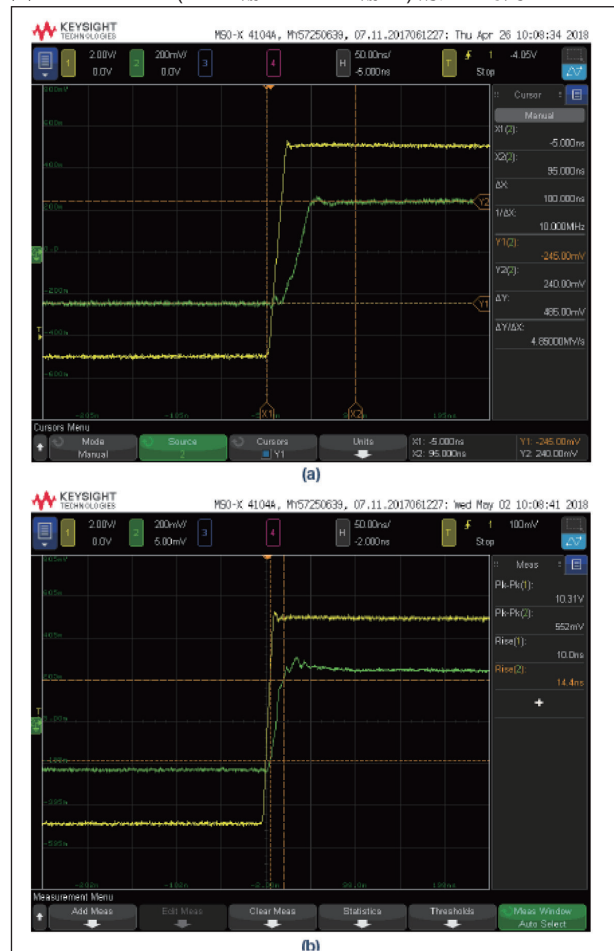
圖 8：ADA4898-2 (CH1- 輸入、CH2- 輸出) 的建立時間
