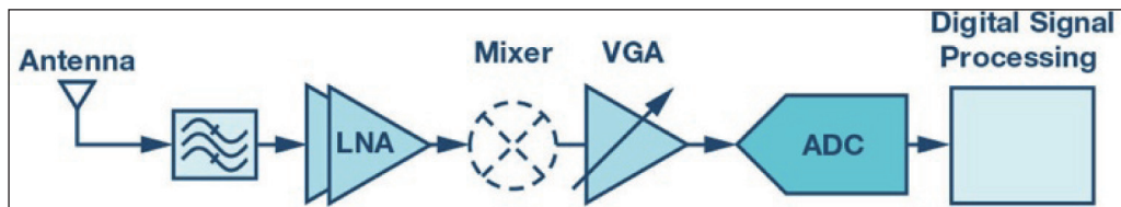
圖 2: 典型的收發器 / 接收器訊號鏈簡圖
