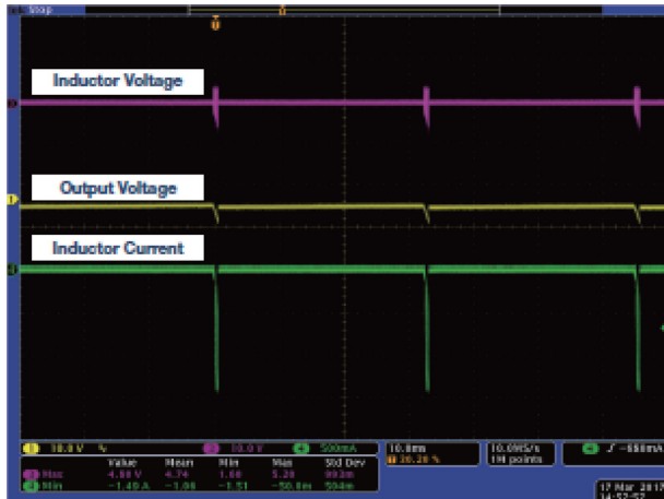
圖 4: 打隔模式下的 ADP5071 反相穩壓器
