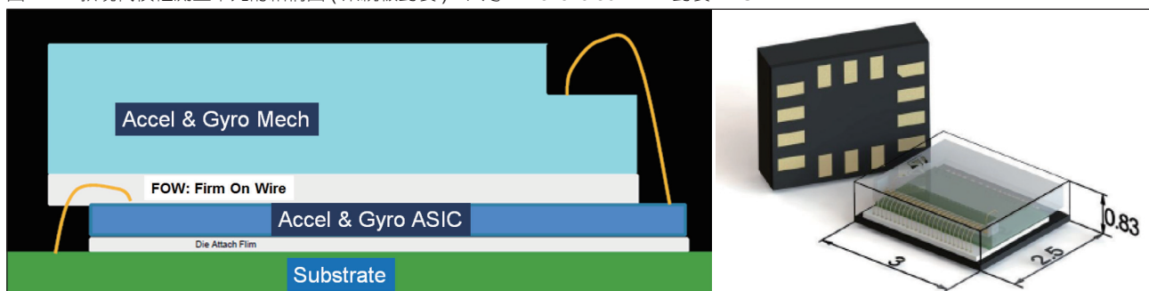
圖 1：一款現代慣性測量單元的結構圖 (系統級封裝)；尺寸：2.5x3x0.86 mm；封裝：LGA-14
