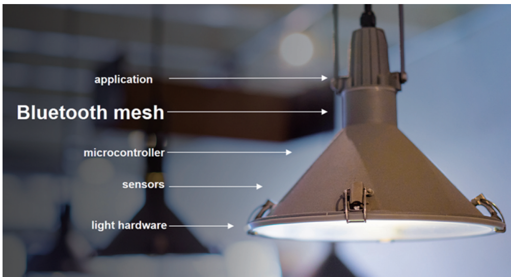
圖 1：藍牙 mesh 照明燈的構成
