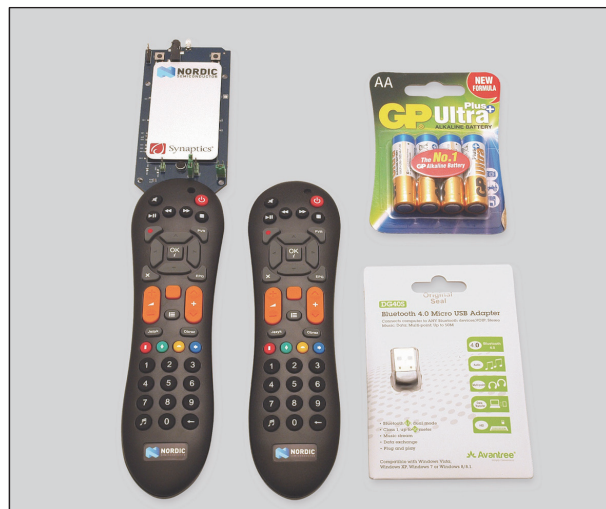
圖 2: Nordic 的 nRFready Smart Remote 3 參考設計使設計人員可以為其語音操控遙控器靈活選擇硬體和軟體
