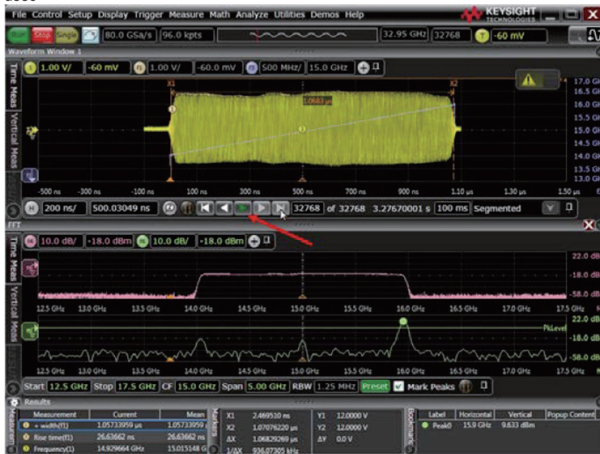
圖 3：33 GHz 示波器的分段式記憶體擷取 32k 個脈衝並放入 32k 個分段，其中每個分段為 1.2 usec
