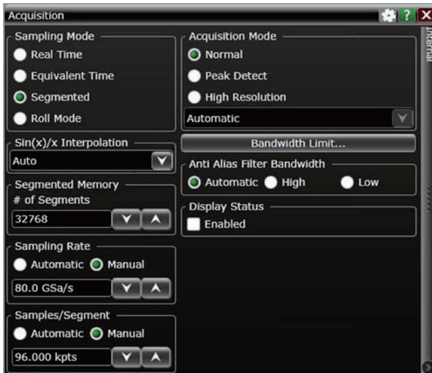
圖 3：33 GHz 示波器的分段式記憶體擷取 32k 個脈衝並放入 32k 個分段，其中每個分段為 1.2 usec
