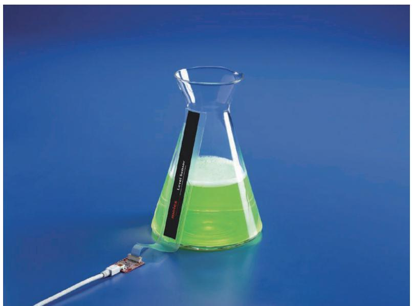
電容式液位感測器還為家電的設計人員提供了更大的自由度，容許使用非傳統形狀的儲存槽，這是採用傳統機械式感測器的產品所無法實現的。感測器電路基板的選項包括印刷電路板、聚酯柔性電路以及聚醯亞胺柔性電路。有些設計可以將傳統的印刷電路板用於平面形狀的容器，或者使用極薄的柔性電路來適應曲面形或者空間受約束的應用，這樣可以縮小應用的整體體積，提高產品設計的效率。
