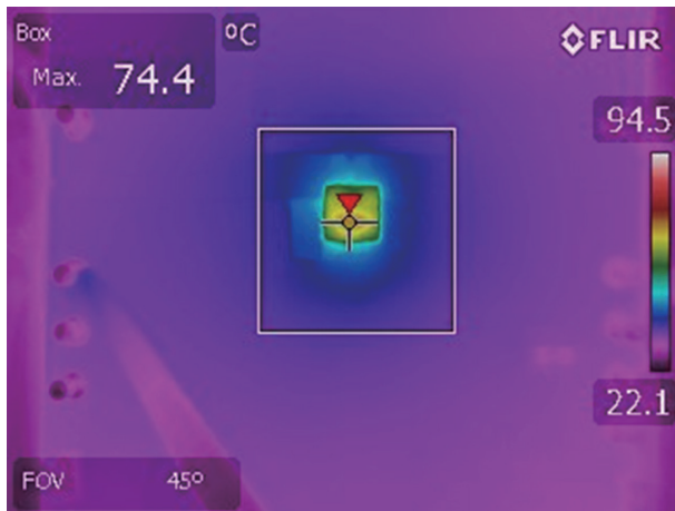
圖 6： V_{IN} = 5V 、 V_{OUT} = 3.3V/5A 、 T_A = 25^{\circ}C 時的熱量分佈
