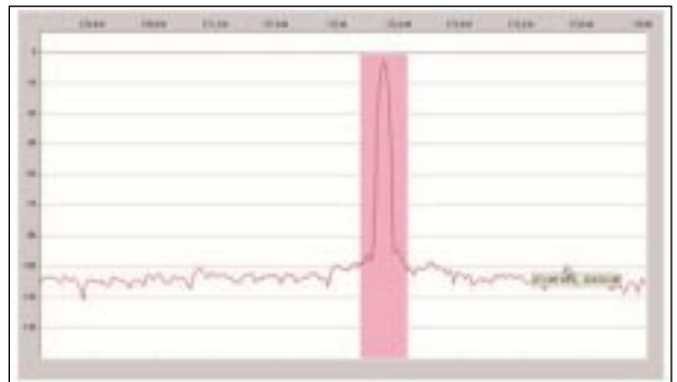
圖 7：位於 785 MHz 輸入中的 1.2 MHz 旁帶交換式突波。突波位準 = - 94 dBFS。
