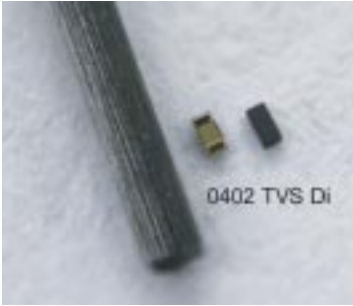
圖說：羅姆電子 0402 TVS 二極體與 0.5mm 粗細的自動鉛筆芯對比
