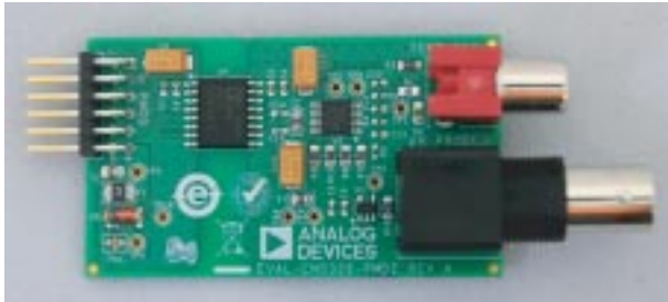
圖說：CN0326 帶有溫度補償功能的隔離式低功耗 pH 監測儀
