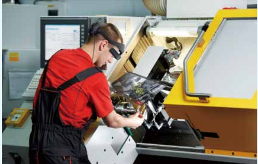
圖說：使用者可透過 AR 智慧眼鏡內建的鏡頭、麥克風及喇叭，在第一現場操作時與後台客服或工程師進行溝通。
