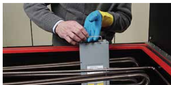
圖說：操作人員正在從液冷設備中拿出伺服器機架
