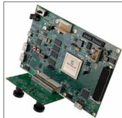
PolarFire FPGA 成像和視頻開發套件可用於設計原型和測試機器視覺應用。除了具有雙攝像頭感測器和各種豐富的外設 I/O 介面，還支援 HDMI 2.0、DSI、MIPI CSI-2 TX/RX 和 HD/3G SDI 等協議。PolarFire FPGA 具有 300k 邏輯元件、4GB DDR 記憶體和用於緩衝的 1GB 快閃記憶體，性能足以應對 4K 影像處理。可廣泛應用於多個市場，包括監控和互聯網協議 (IP) 攝像頭、車載和其他無線與移動用例、機器視覺與醫療、智慧家居以及在工業、航太與航空及國防領域的其他應用。
