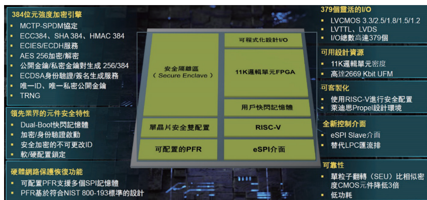
圖說：Mach-NX FPGA 分為幾大重點區，並延用傳統 FPGA 模塊以及功能
