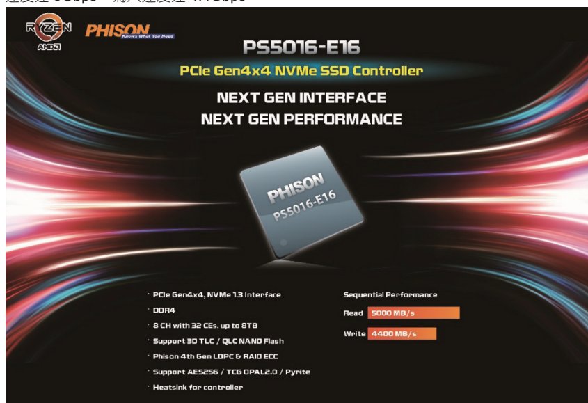
圖 3：群聯發佈全球首個 PCIe Gen4x4 NVMe SSD 解決方案——PS5016-E16，配合第三代 AMD Ryzen (首款支援 PCI-Express 4.0 的處理器) 可提供兩倍的儲存頻寬，E16 讀取速度達 5Gbps、寫入速度達 4.4Gbps
