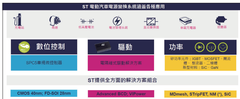
圖 1：新能源汽車的三大電源模組
