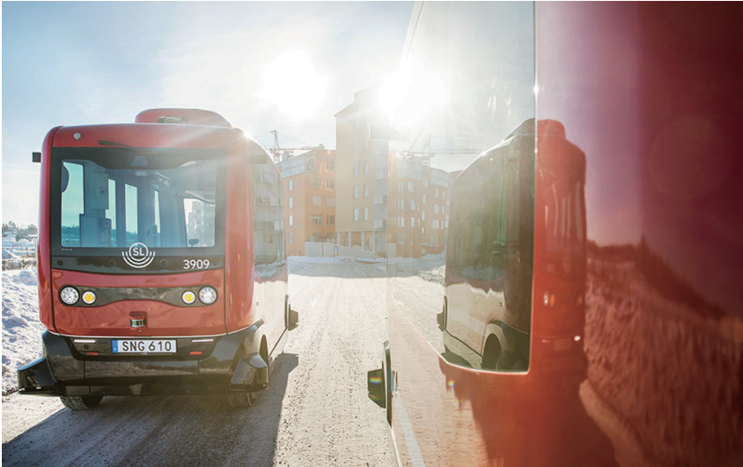
圖 2：配備 Velodyne 光達感測器的 EasyMile EZ10 自駕車，可在積雪反光的道路正常行駛
