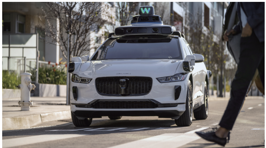
圖 3：第五代「Waymo Driver」光達、攝影機和雷達皆具有不同視野要求，故需仔細確定硬體和外觀設計的位置，以確保這些模組不會相互掣肘
