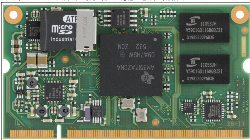
圖 1：插卡之嵌入式系統，具有處理器、記憶體、電源和外部接口
