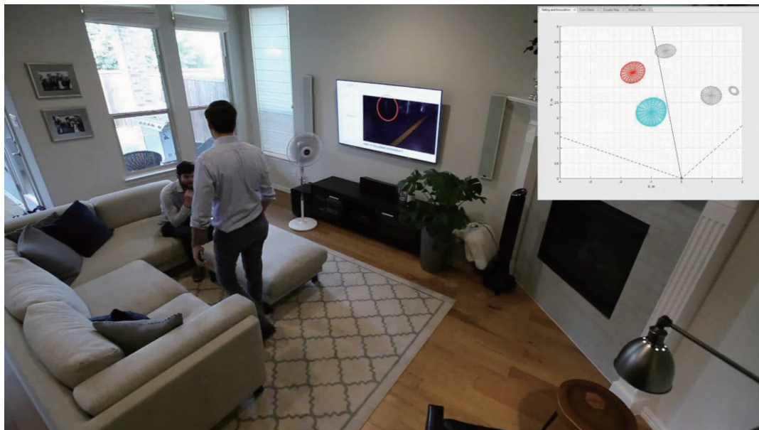
圖 3：使用 60GHz mmWave 感測器進行人員分類 (右上角紅色和藍色標示)，以及誤檢測緩解 (灰色)
