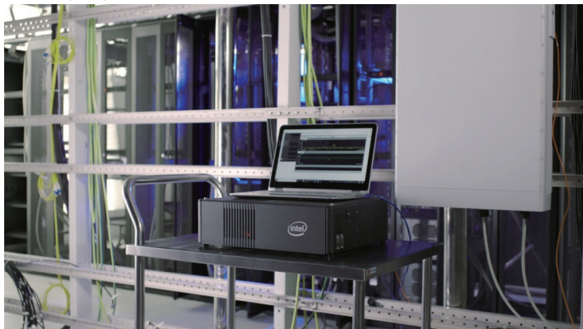
圖 2：使用愛立信 5G NR 基地台和英特爾 5G NR UE 平台，在 3.5GHz 成功運行互操作性開發測試 (IoT)
