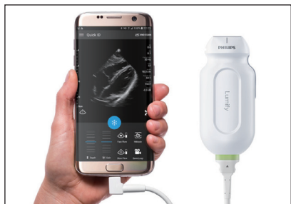
圖 4：飛利浦 Lumify 可攜式超音波透過 USB 連接手機或平板，在專屬 APP 取得超音波圖像
