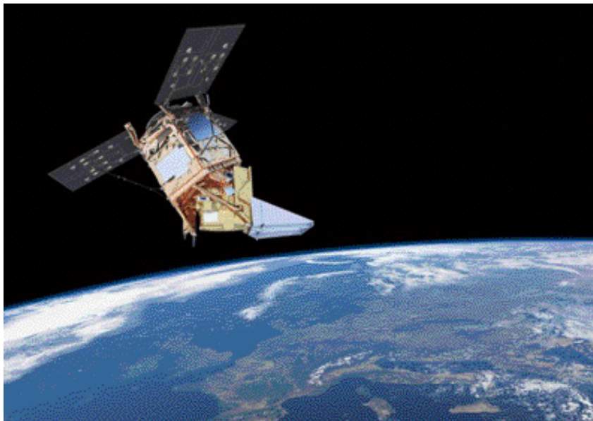
圖 4：Sentinel-5 Precursor 攜帶一台 Tropomi 成像光譜儀，能及時提供影響空氣品質與氣候的多種微量氣體和氣溶膠數據
