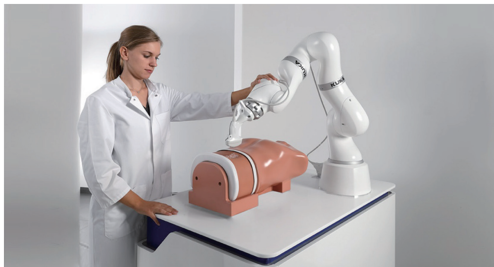
圖 1：KUKA LBR Med 具備非常靈敏的關節扭矩感測器，可進行安全的人機協作，用於輔助內視鏡檢查、雷射手術切割骨骼或植入骨釘
