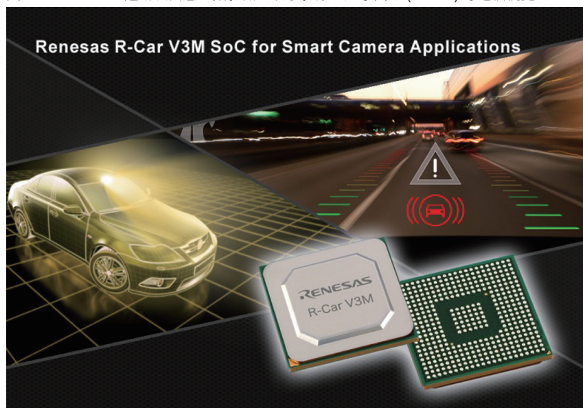
圖 4：R-Car V3M 適用於智慧型攝影機、環景影像、光學雷達 (LiDAR) 等電腦視覺
