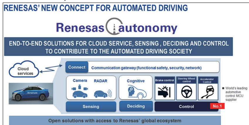
圖 3：瑞薩「Autonomy」開放平台，貫穿感測、認知決策、控制及雲端服務
